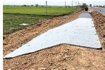
22年工法(手前)と現工法(奥側)の比較試験状況
